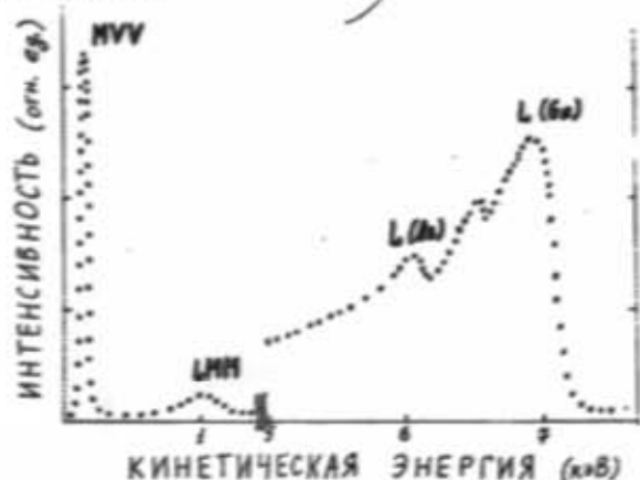
Рис. 2 Энергетический спектр электронов, выходящих из кристалла GaAs при поглощении \text{CuK}_\alpha -излучения.
