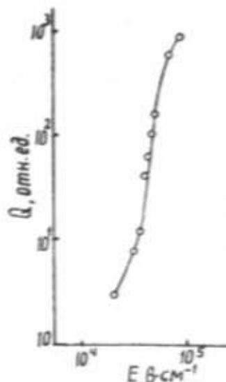
Рис.1. Зависимость величины положительного заряда, переносимого в многослойной структуре фотомишени, от напряженности электрического поля.
