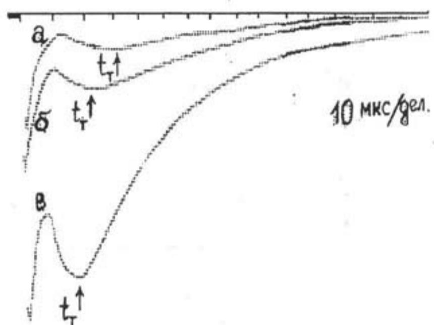
Рис. Осциллограммы импульсов фототоков для электронов в ХСП состава  $Se_{95}Te_5$  при различных напряжениях, приложенных к образцу.
