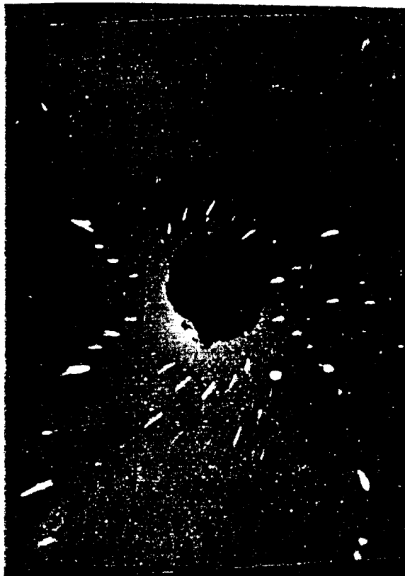
Рис.1. Лауэграмма монокристалла селена, полученного из расплава под давлением 4.5 Кбар.
