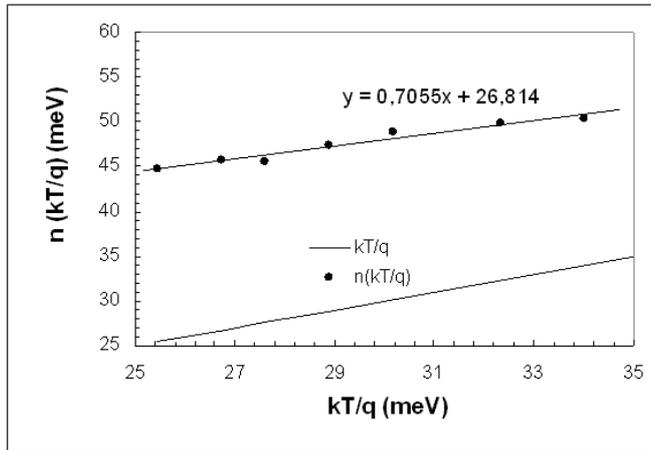
Fig. 2. Tunnelling current parameter  $E_o$  ( $nkT/q$ ) -  $kT/q$  for Al/p-Si Schottky diode
