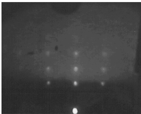
Рис.1. Электронограмма эпитаксиальной пленки Pb_{1-x}Mn_xSe ( x=0,01 ).
