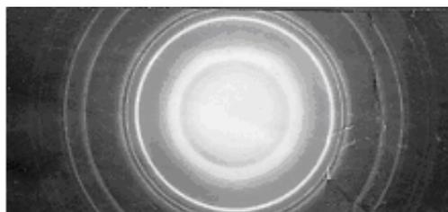
Рис.2.а. Электронограмма поликристаллической пленки GaSe.
