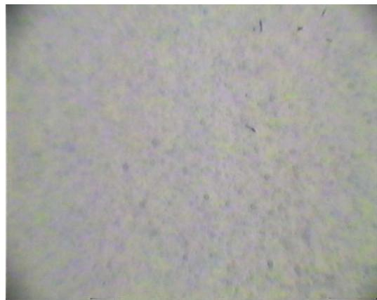
Рис.2 Поверхность (111)A InSb после травления в молочнокислотном травителе (x250)
