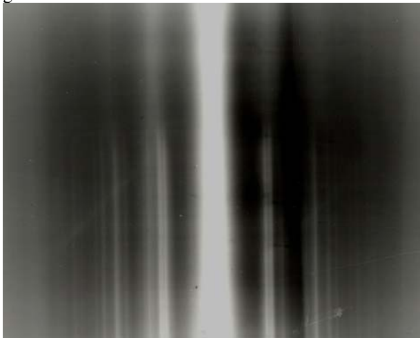
Şək.11. 548 K temperaturda kristallaşan amorf Yb_{1-x}Sm_xAs_2S_4 təbəqənin izotermik kinematik elektronogramması
