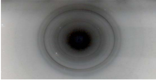
Şək. 1. Yb_{1-x}Sm_xAs_4S_7 polikristal fazasından alınmış elektronogramma
