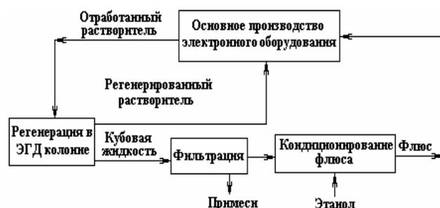
Рис. 3. Технологическая схема регенерации спирто-бензиновой смеси
