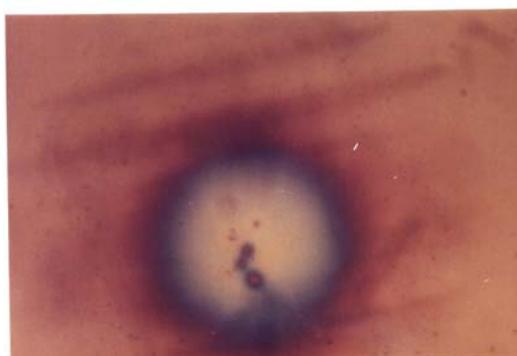
Рис.6. Разбег полос скольжения от отпечатка после температурного отжига ( $T=1000^{\circ}\text{C}$ )
