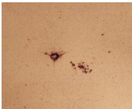
Рис.5. Разбег дислокаций от отпечатка индентора после температурного отжига( $T=600^{\circ}\text{C}$ ).
