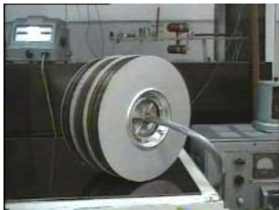
Рис. 4 Резистор с подавлением высокочастотных компонент для защиты устройств электротехнического оборудования.
