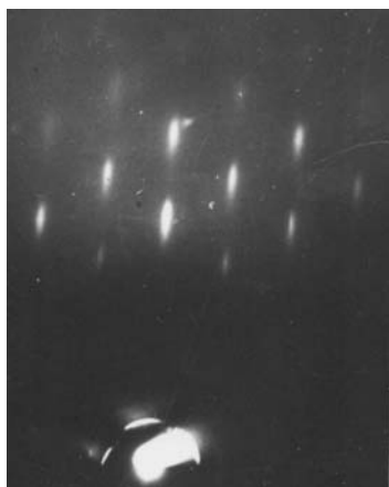
Рис.1.а.Электроннограмма пленки PbSe_{1-x}Te_x ( x=0,2 ); a=6,19 \text{ \AA} ;
