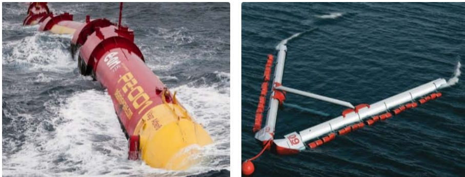
Şək.7. "Dəniz ilanları" və "Duzlu ördək" prinsipi ilə işləyən dalğa elektrik stansiyaları.
