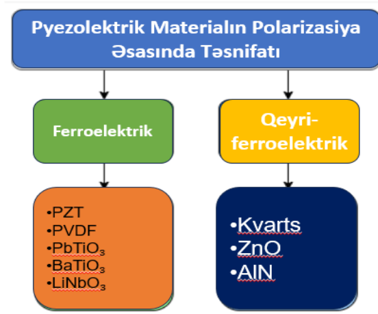
Şək.1. Müasir mühəndislik tətbiqlərində istifadə olunan pyezoelektrik materiallar.
