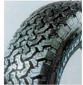
Şinin səthində relyef cizgiləri sürtünməni artırmağa xidmət edir.
