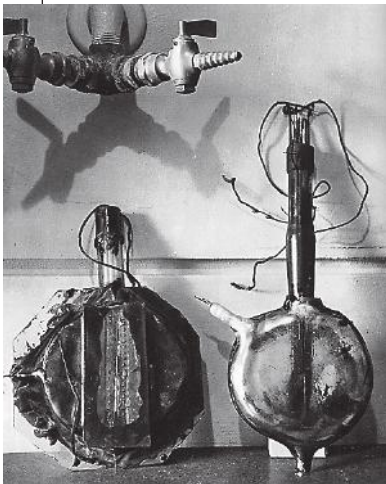
▲ E.Lourensın və N.Edelfsenin konstruksiyası olan ilk tsiklotronun vakuüm kamerası. 1930-cu illər.
