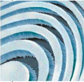
Elektron dəstəsilə qalınlığı 0,33 mkm olan zolaqlara “bölünmüş” silisium monokristalının elektron mikroskopunda görünən fraqmenti.
