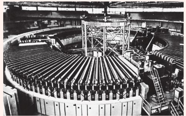
Berkliyə (ABS) Kaliforniya universitetində bevatron – 6,2 QeV enerjili sürətləndirici.
