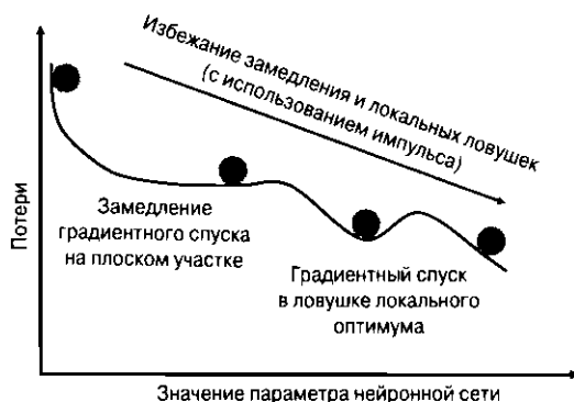
Рис. 3.12. Роль импульса в навигации по сложным поверхностям функции потерь. Импульс содействует сохранению постоянной скорости процесса оптимизации на плоских участках поверхности функции потерь и помогает избежать попадания в локальные оптимумы
