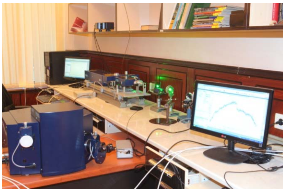
Рис.3.3.1. Схема экспериментальной установки для измерения фотолуминесценции кристаллов GaS излучением Nd:YAG-лазера.
