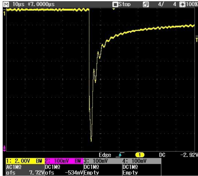
Şəkil 4.6.5. CdS nazik təbəqələrində fotokeçiriciliyin ossilloqramması.
