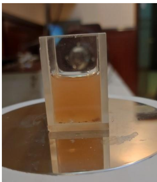
Şəkil 1.5.2.2. Maye mühitdə GaSe-nin lazer ablyasiyası ilə əldə edilən colloid məhlul.
