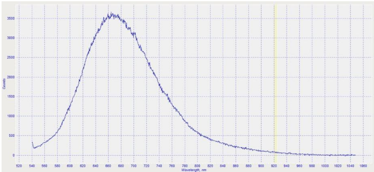
Şəkil 3. CuAlS 2 monokristalı, Lümünisensiya(L1), E_g=1,84\text{eV}
