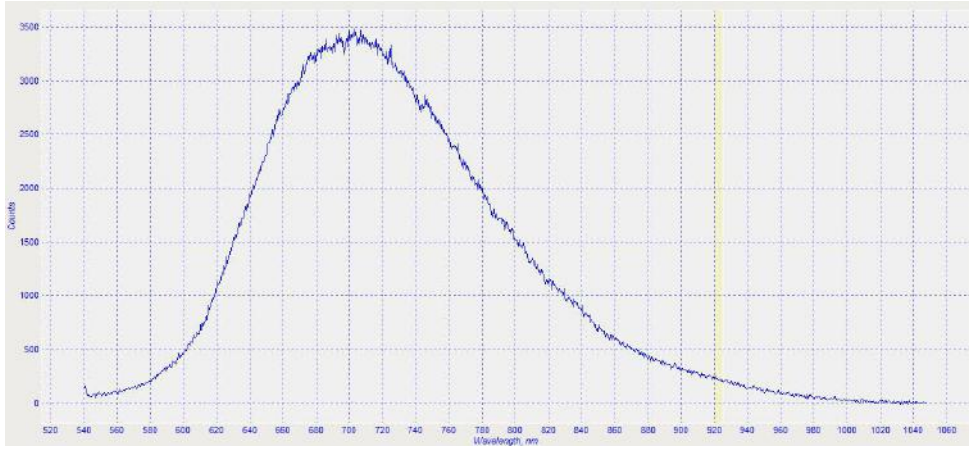
Şəkil 10. CuAlS 2 monokristalı, lüminessensiya (L2), E_g=1,77\text{eV} .
