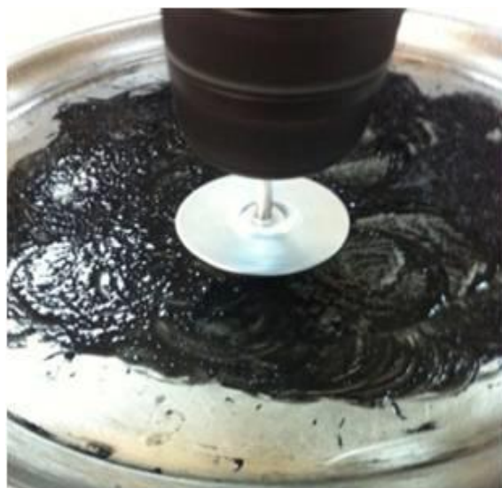
Şəkil 5. Qeyri-funksionallaşdırılmış KNB-ların epoksid qətranda dispersiya prosesi.
