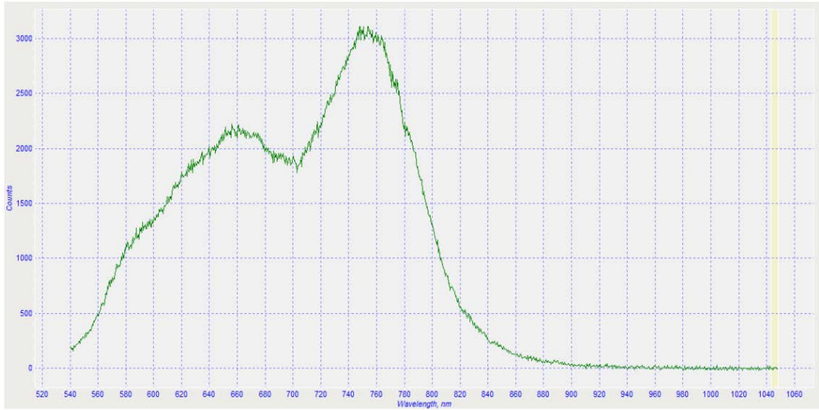
Şəkil 4. CuAlSe 2 monokristalında lüminessensiya. Birinci zolağın enerjisi E_1=1,9 eV; ikinci zolağın enerjisi E_2=1,63 eV.
